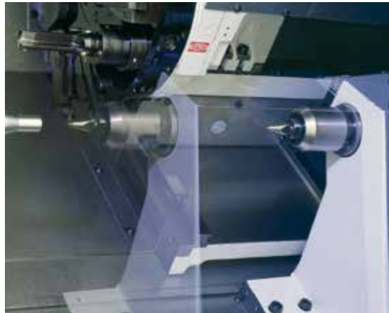
Задняя бабка предлагает большой, автоматически регулируемый диапазон.
