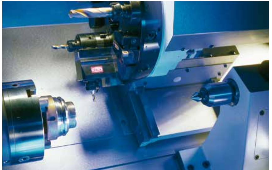
Просторная рабочая зона и быстро переключающийся револьвер дискового типа с 12 посадочными отверстиями под инструмент. Внутренняя подача СОЖ и система логического направления поворота - уже в базе.
