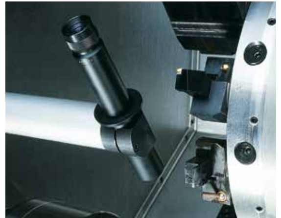
Система настройки инструмента TRAUB ATC также входит в базовое оснащение.
