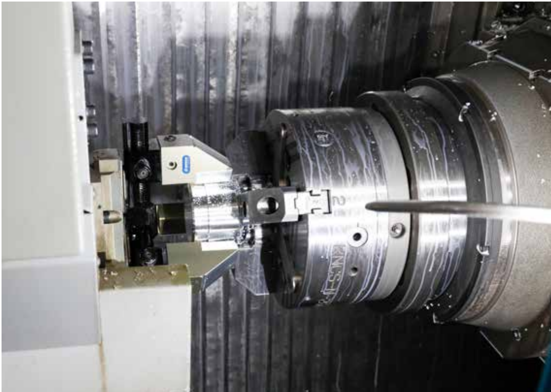
Rohteile werden bei Weber-Hydraulik auf ein Rundtaktband gelegt und vollautomatisch über das integrierte 2-Achs-Werkstückhandling mit einem 3-Backengreifer von Schunk zu- und abgeführt.
